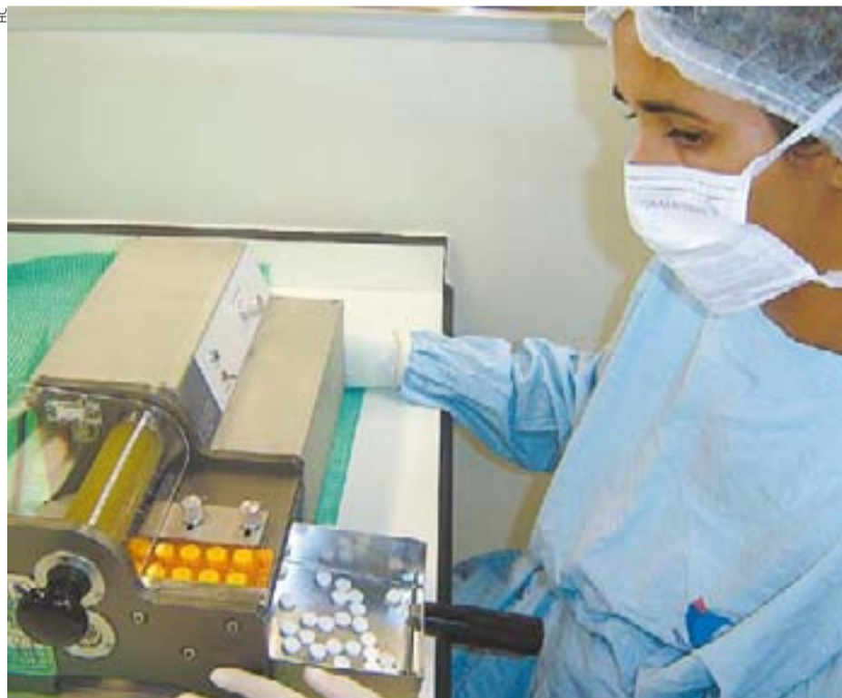
Equipamento desenvolvido no HC é capaz de deblistar oito mil unidades por hora
